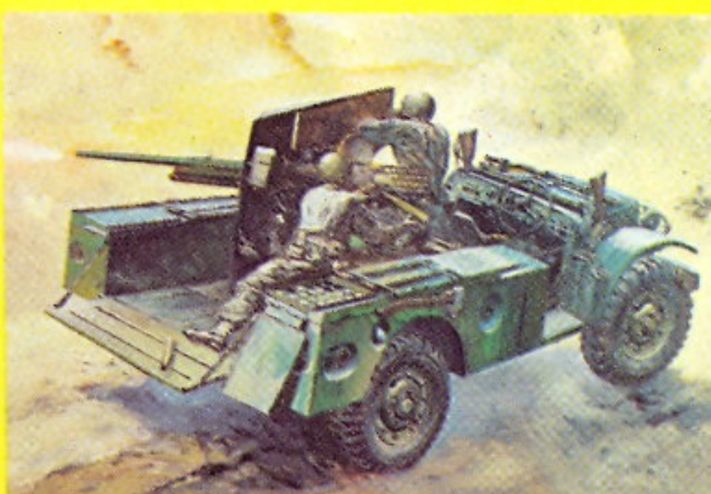
M6-PANZERJÄGER 07361-3 In der letzten Kriegssphase erfolgreich gegen Panzer und Befestigungen eingesetztes Fahrzeug: auf das Dodge 4x4 Fahrgestell gesetzte, bewegliche 37mm PaK.
