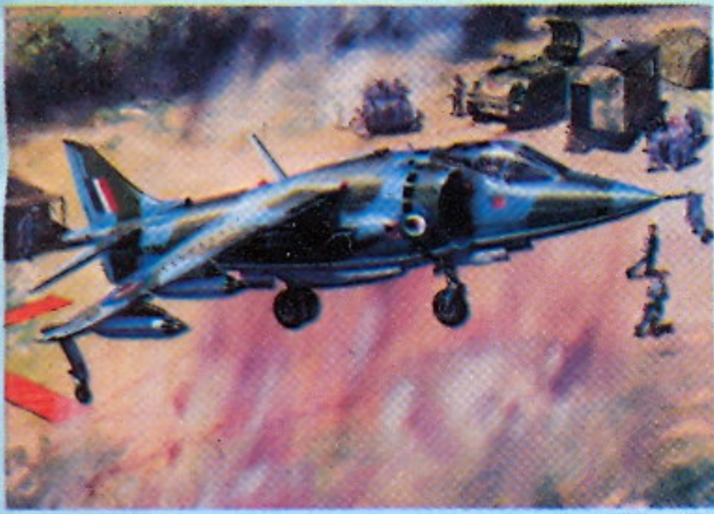
HAWKER SIDDELEY 'HARRIER' GR.1 02036-5 Erster, aus der P.1127 entwickelter V/STOL-Jagdaufklärer der Welt, bei der US-Marine als AV-8A eingesetzt und mit der RAF auch in der Bundesrepublik stationiert.
