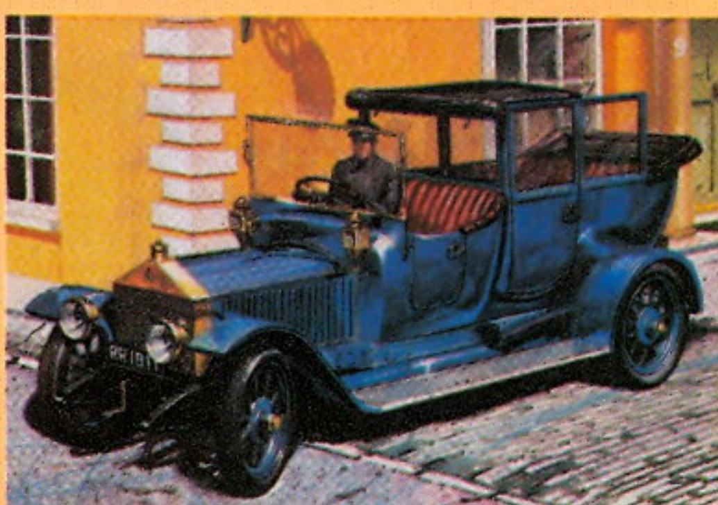
ROLLS-ROYCE 1911 02444-2 Einer der ersten RR-Sechszylinder, erreichte mit 50 PS etwa 160 km/h Spitze. 28 Teile, 14cm lang.
