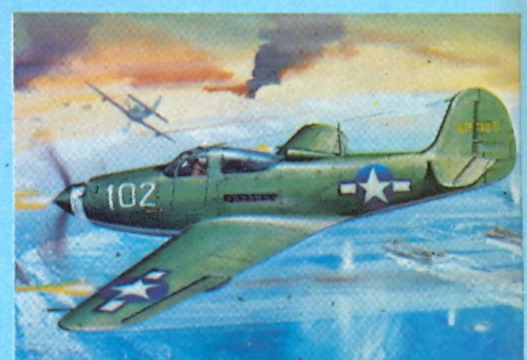
BELL P-39Q 'AIRACOBRA' 01039-1 Unorthodoxer Motoreinbau hinter dem Führersitz und Bugradfahrwerk kennzeichnen diese, auch 'Fliegendes Kreuz' genannte Maschine. Mit amerikanischen und sowjetischen Markierungen. 39 Teile, 12,5cm lang.
