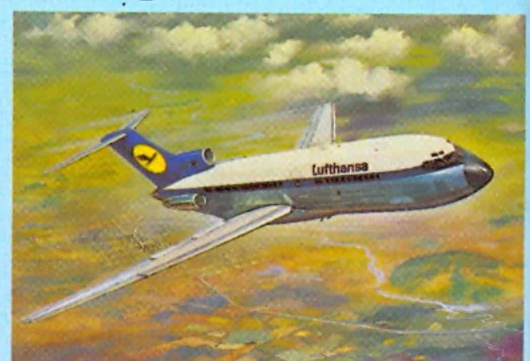
BOEING 727 'EUROPA-JET' 03173-6 Mit 'sauberem' Flügel und drei Turbinen im Heck kostete die Entwicklung über eine Milliarde Dollar. Heute ist die '727' auf allen Flughäfen und bei den meisten Gesellschaften, auch bei der Lufthansa, zuhause. Mit Markierungen der Lufthansa.
