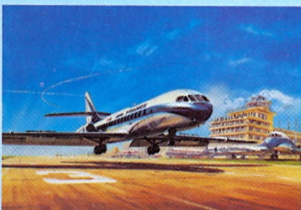
SUD S.E. 210 CARAVELLE 03177-8 Die Caravelle, Frankreichs erfolgreichstes Zivilflugzeug der Nachkriegszeit, bot als erster Jetliner mit Hecktriebwerken dem Passagier einen vergleichsweise ruhigen und schwingungsfreien Flug.
