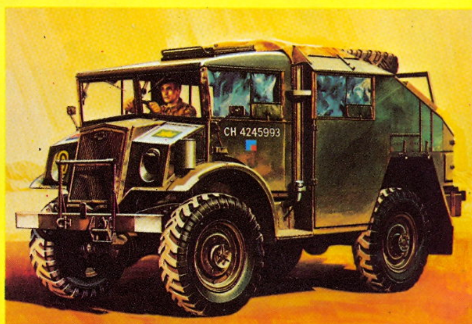
FELDGESCHÜTZ-ZUGMASCHINE 08368-7 In die Reihe kanadischer Militärfahrzeuge gehörig, kam dieser Geschützschlepper von Chevrolet weitgehend bei englischen und Commonwealth-Streitkräften im zweiten Weltkrieg zum Einsatz. Hauptsächlich als Artillerie-Traktor verwendet, bot dieses Fahrzeug Platz für die Geschützbedienung, Munition und Ausrüstung.
